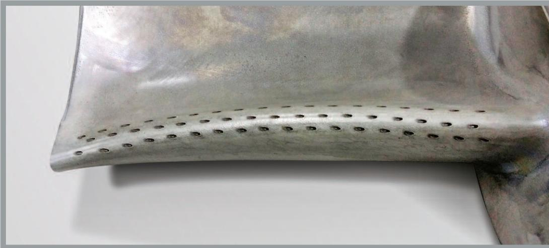
**Bild 4. Turbinenschaufel mit Kühlluftbohrungen, die gleichmäßig und in Reihen angeordnet sind**
