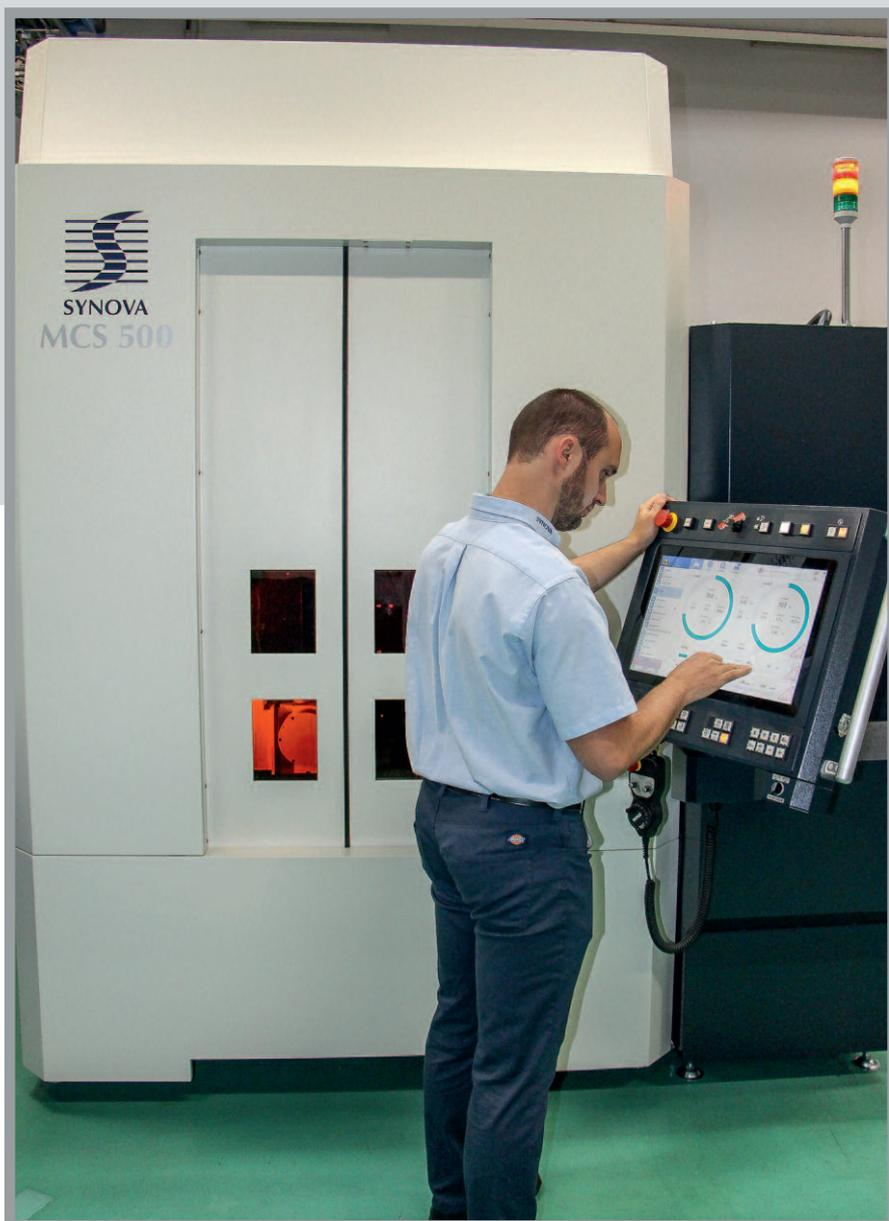
**Bild 6. Eine »MCS 500« von Synova, die für eine 3D-Bearbeitung mit dem LMJ-System ausgestattet ist**
