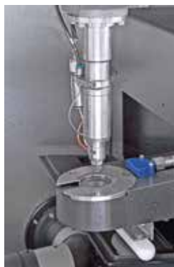
Prozess überwachen: Eine Messzelle erfasst die Laserenergie innerhalb des Wasserstrahls.
