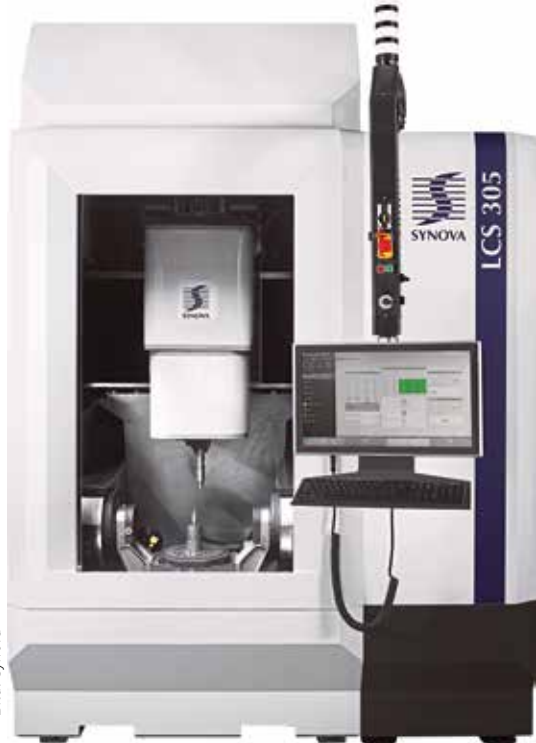
Für die Praxis: Mit dem Verfahren Laser MicroJet arbeiten des 5-Achs-Bearbeitungszentrum.
